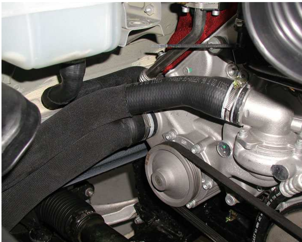
58. 从节温器和泵上断开两根发动机冷却管路。
