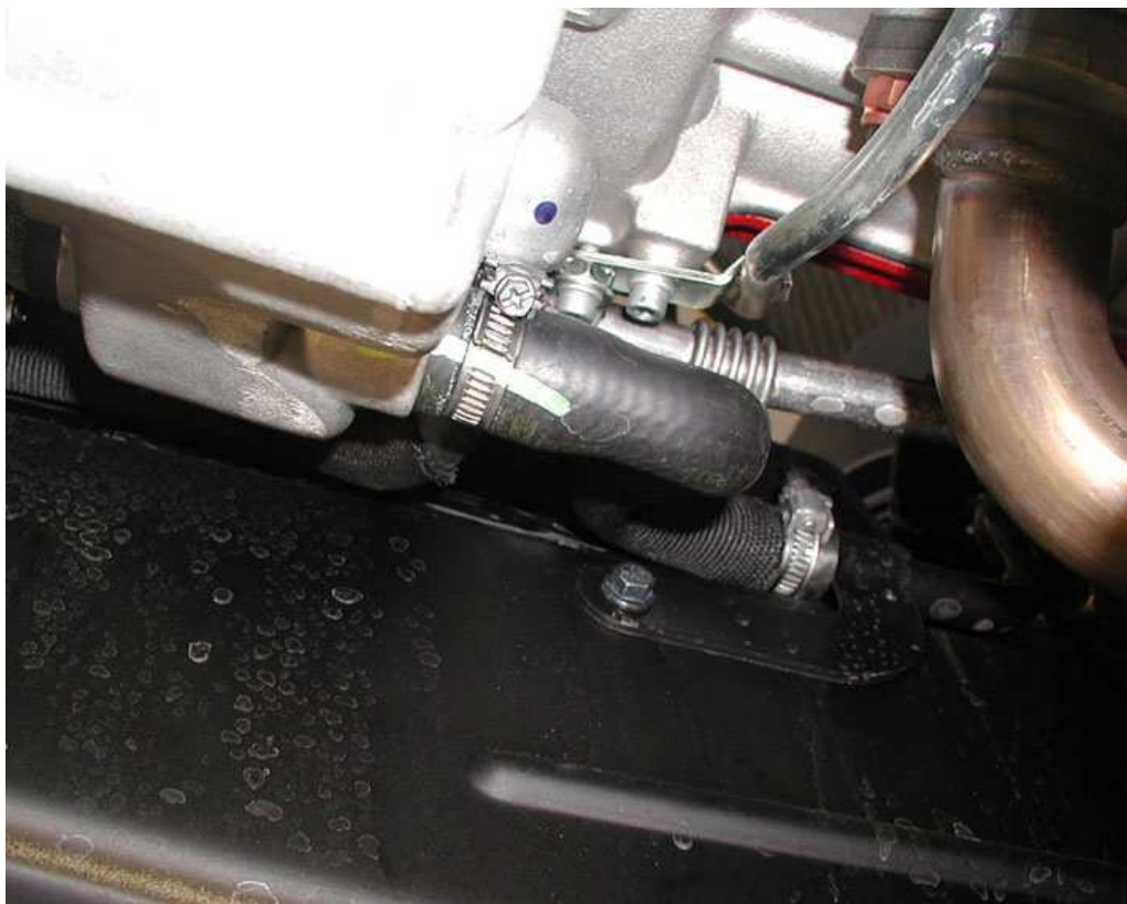
59. 断开与TGK节流阀相连的发动机冷却液输送管路。
