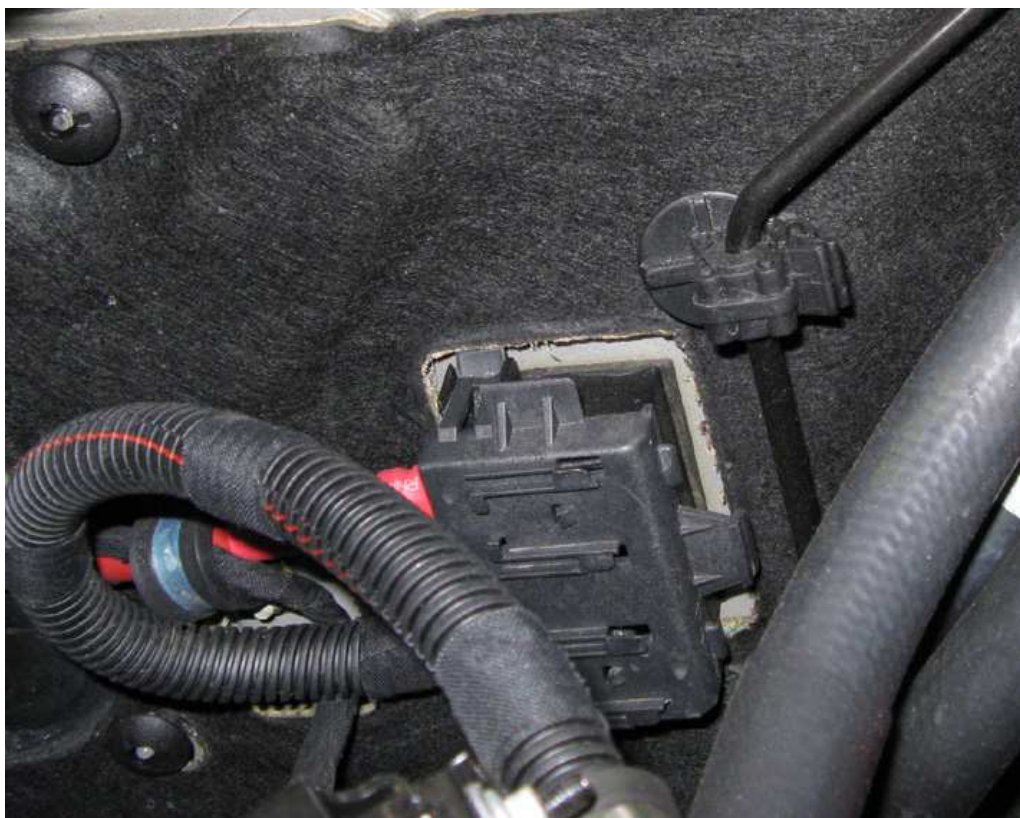
18. 断开燃油蒸汽开关电磁阀接插件。
