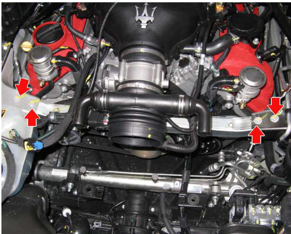
58. 从节温器和泵上断开两根发动机冷却管路。
