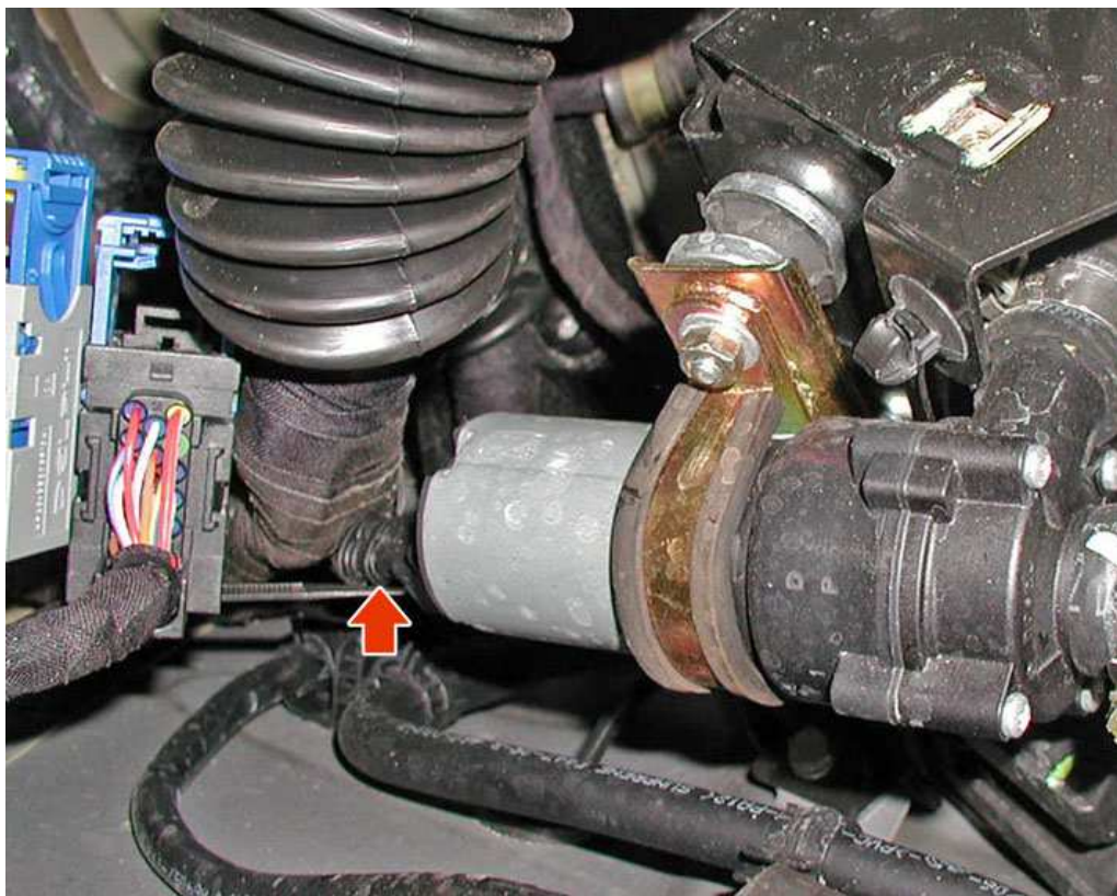
19. 断开辅助水泵接插件。
